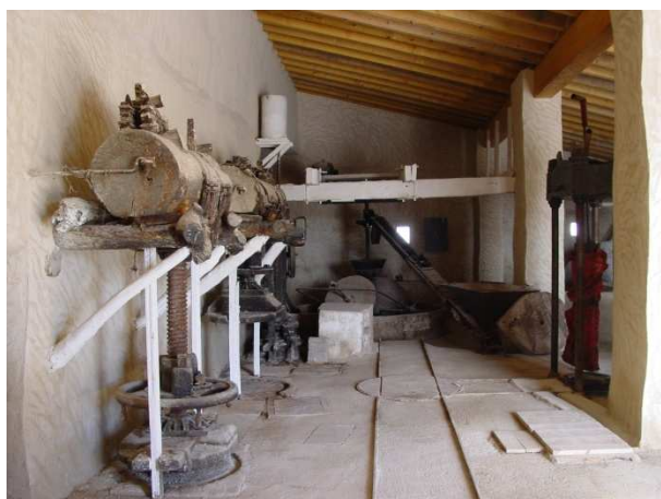
3. A la izquierda prensas manuales, raíles de la vagoneta de alimentación, y al fondo el molino mecánico con la tolva de alimentación.
